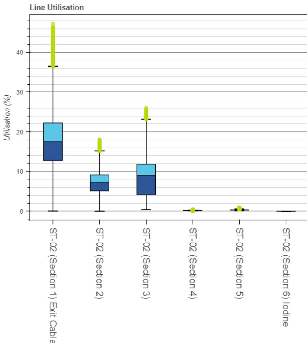
**Figure 12 - Existing ST-02 11kV feeder utilisation**
