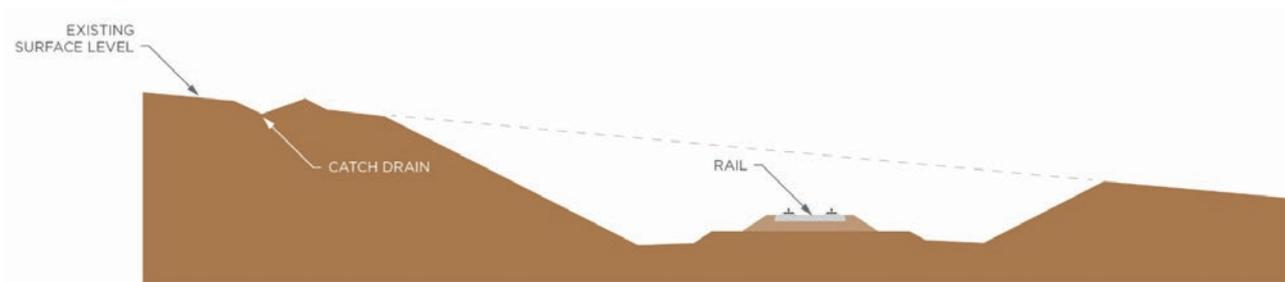
FIGURE 6.15: TYPICAL LONGITUDINAL DRAINAGE FOR RAIL FORMATION WITHIN A CUT
