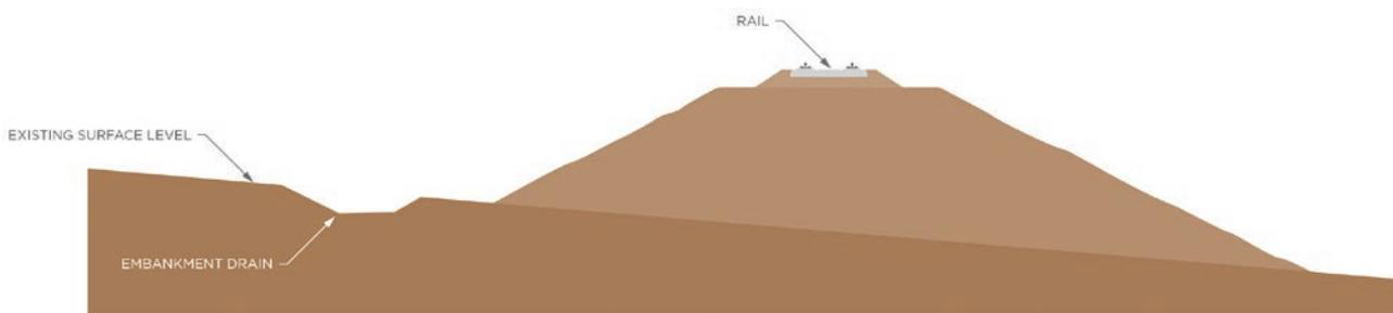
FIGURE 6.14: TYPICAL LONGITUDINAL DRAINAGE FOR RAIL FORMATION ON TOP OF EMBANKMENT
