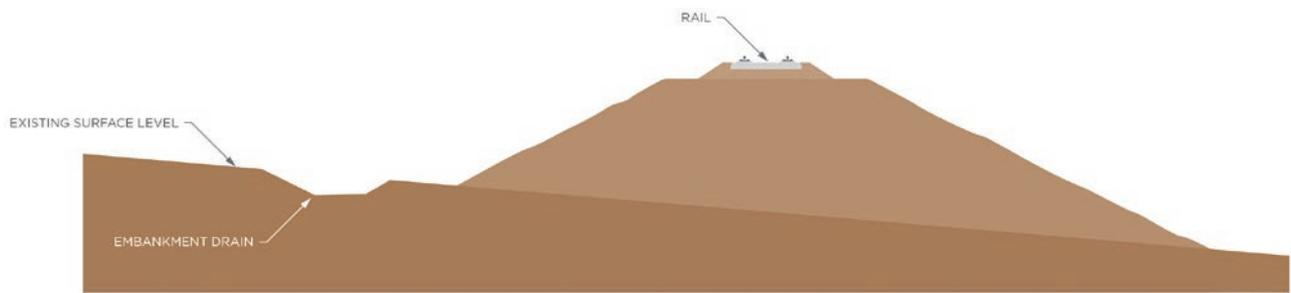
**FIGURE 7: TYPICAL LONGITUDINAL DRAINAGE FOR RAIL FORMATION ON TOP OF AN EMBANKMENT**
