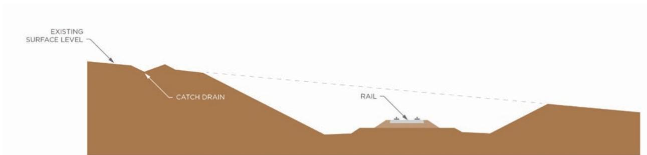
**FIGURE 8: TYPICAL LONGITUDINAL DRAINAGE FOR RAIL FORMATION WITHIN A CUT**
